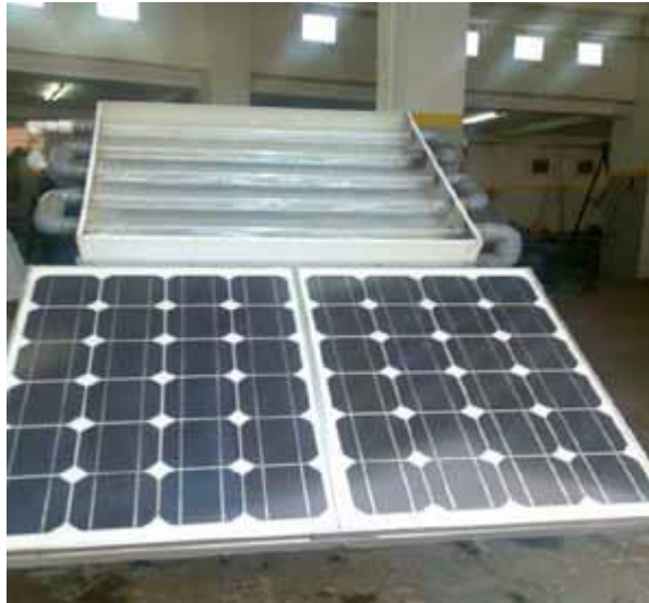
Fig. I.7: Prototype du réacteur photocatalytique tubulaire (Unité de Développement des Équipements Solaires UDES (Bou Ismail, Tipaza) 2010).
