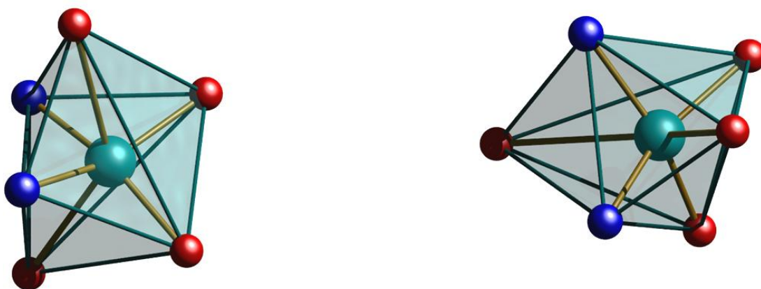
Figure III. 55: Sphère de coordination de l'atome de Cuivre
