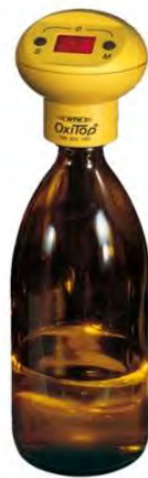
Figure II.18 : Le type de bouteille Oxitop utilisée lors de la mesure de la DBO 5 .
