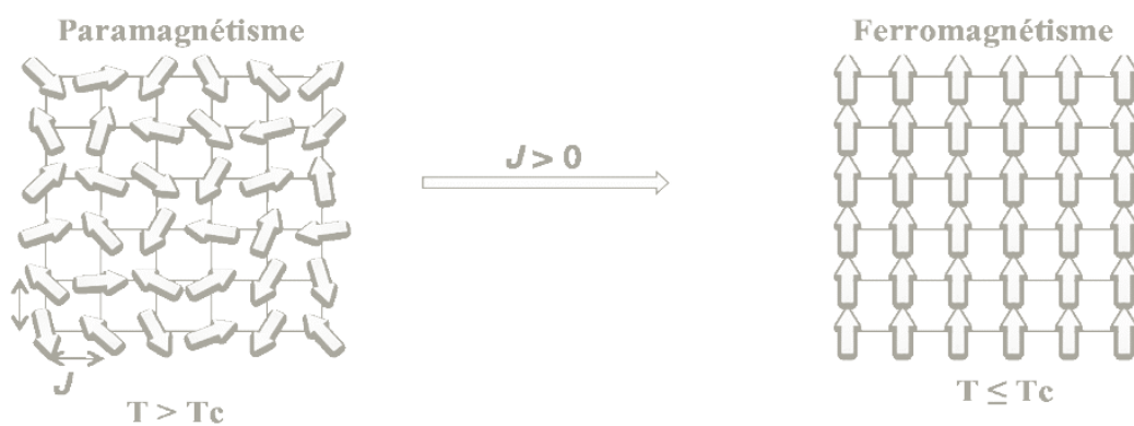
Figure 4. Représentation schématique de l'orientation des moments de spin lors d'une transition de l'état paramagnétique à un état ferromagnétique.
