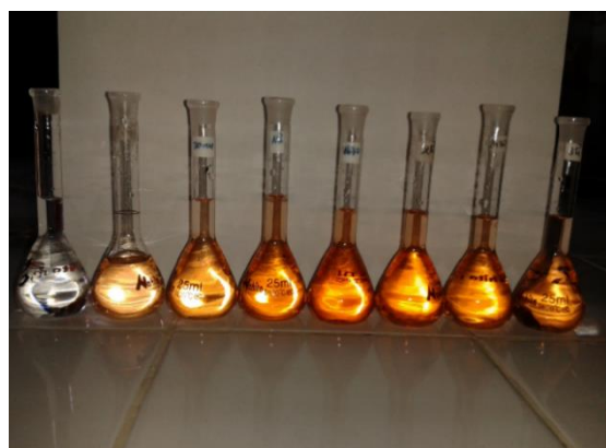
Figure V.24 : Effet de l'addition d'ions ferreux ( 5 \times 10^{-4} M) sur la photodissolution du MN à 365 nm ( 5 \times 10^{-3} M acide oxalique, pH 2,4 et à 20 \pm 1 °C).
