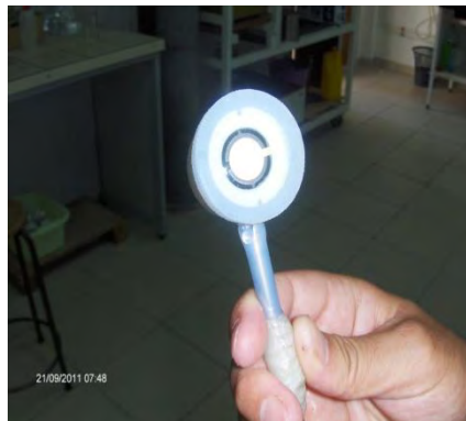
Figure 16: Schéma des deux faces du cristal de quartz et de son montage dans une microbalance (NGUYEN, 1996).
