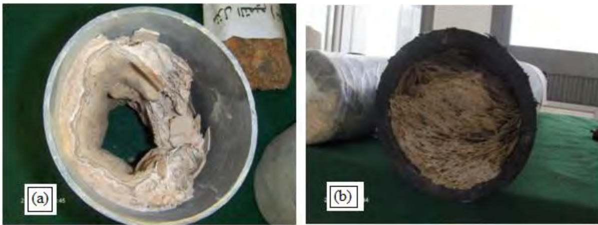
Figure 1: Photos des dépôts de tartre de carbonate de calcium dans la canalisation métallique (a) et non métallique (b).
