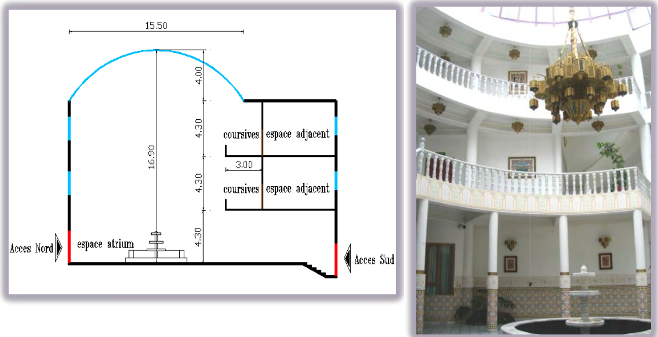
Figure IV. 10: vue en coupe de l'atrium
