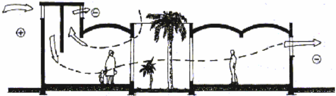
Fig 2.10 : Système traditionnel de ventilation transversale utilisé fréquemment dans les régions chaudes
