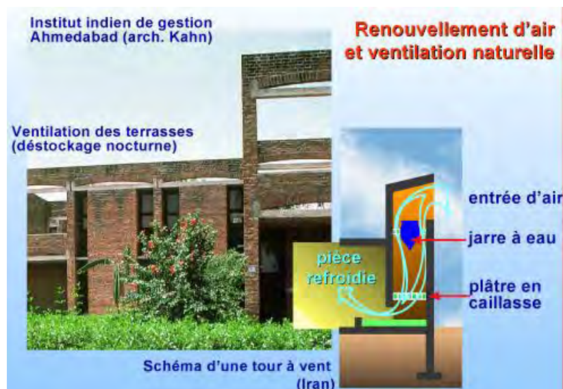
Figure N°12 :Logements de l'Indian Institute of Management (Inde) et schéma d'une tour à vent (Iran).
