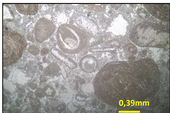
Photo 74 : Packstone à grainstone essentiellement à oncoïdes, et intraclastes
