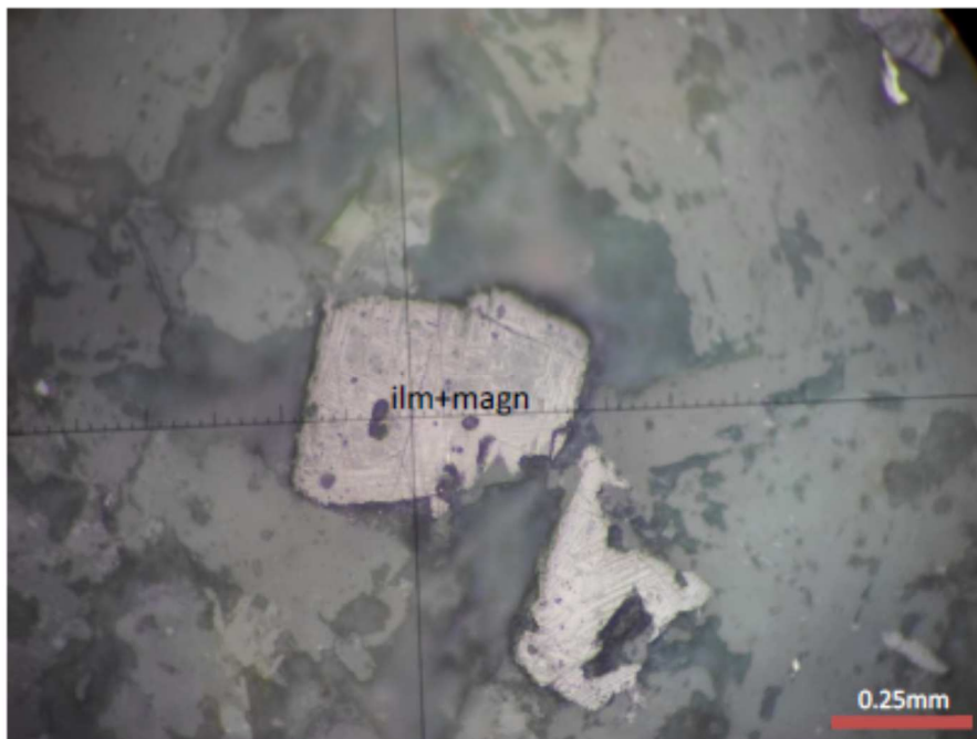
Figure 34: Section polie BL6, Exolutions lamellaires d'ilménite dans la magnétite
