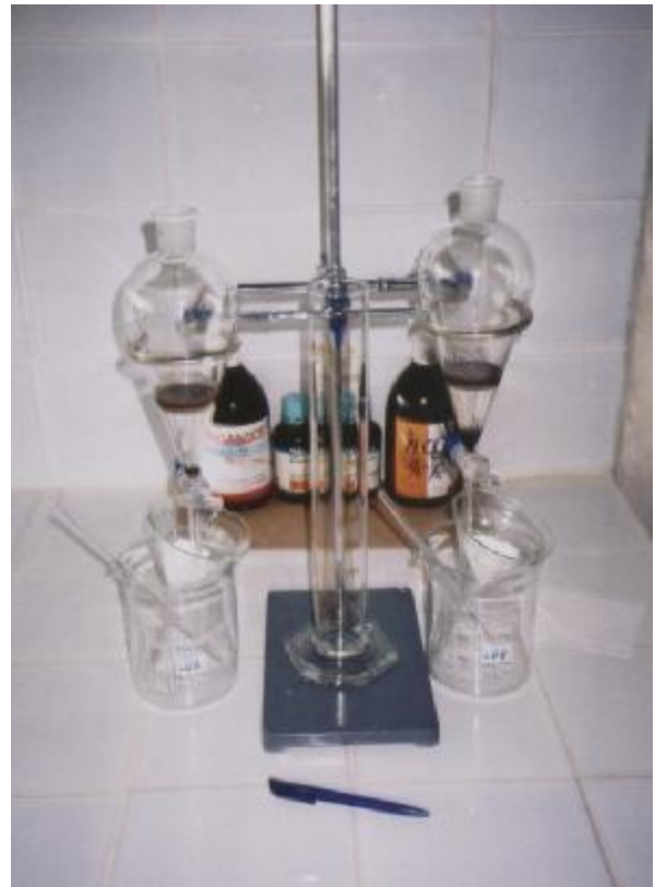
Photo VI.1- Appareillages utilisés pour la séparation densimétrique. (Laboratoire de Génie Géologique de Jijel)
