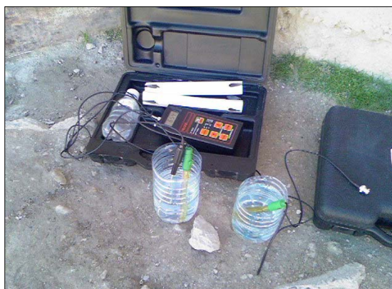
Fig. 107 : Matériel en sondes, utilisé sur terrain. à droite conductivimètre et à gauche le deux sondes (T°C, pH et Potentiel électrique)
