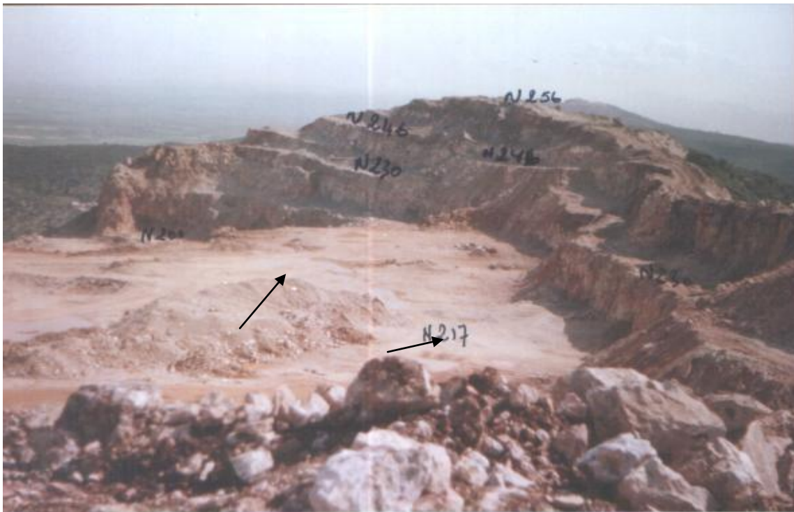
Photo 8.5b- Carrière de Ben Azzouz, vue vers le SE (2007), avec gradins numérotés N 217... Les flèches indiquent le sens de l'échantillonnage qui est aussi le sens de progression de l'exploitation.
