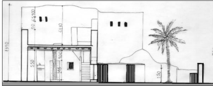
Fig. III.16 : Coupe montrant le « Ouast-Eddar » et la terrasse.
