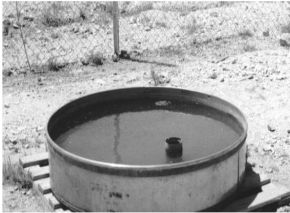
Photo 5 : Bac classe A installé à proximité de la retenue du barrage de Foum El Gherza ( Rémini, 2005 )
