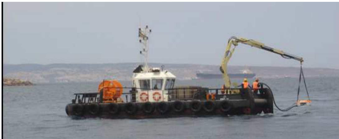
Fig 105 :Un récupérateur mécanique de déchets solides, EP. Skikda
