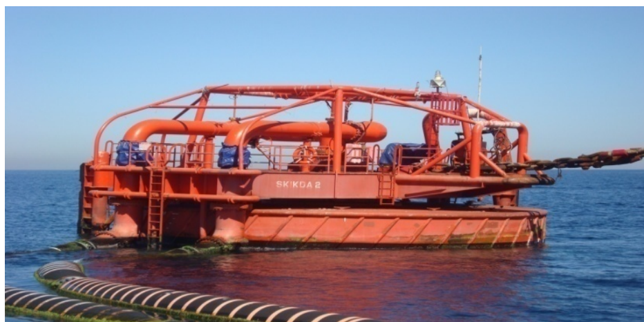
Fig 94 :La bouée flottante de chargement des hydrocarbures liquides, nouveau port de Skikda
