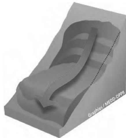
Fig. 9 : Glissement de terrain
