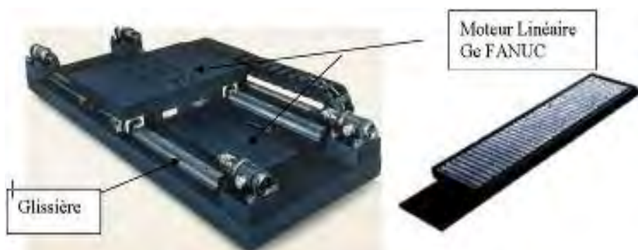
Figure II-8: Glissière actionnée par des moteurs linéaires [31].
