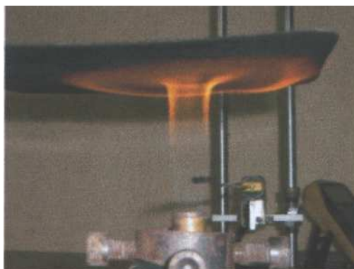
Figure. II.2. Flamme stagnée par une plaque
