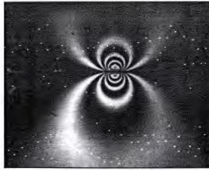
**Fig. 16. Image de photoélasticité qui montre le champ de déformation
