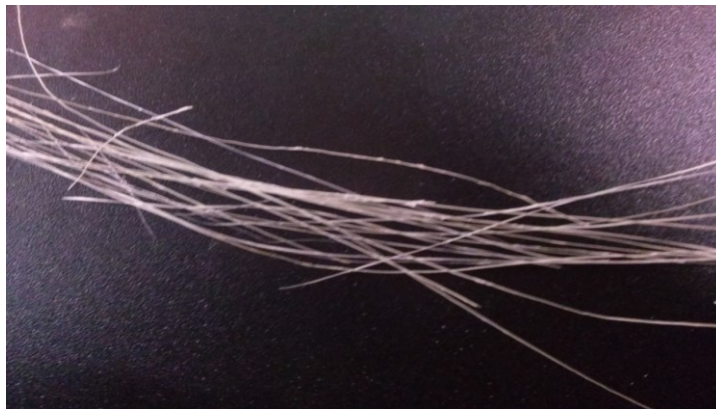
Figure 3.4. Vue macroscopique des fibres de typha de type A.
