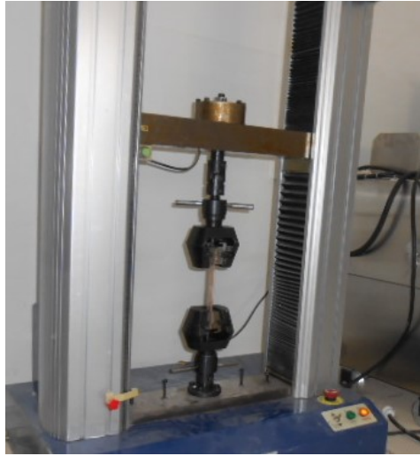
Figure 6.5. Installation de l'éprouvette en composite sur la machine TE avec cellule de charge de 10KN (Laboratoire de l'université KASDI Merbah Ouargla.)
