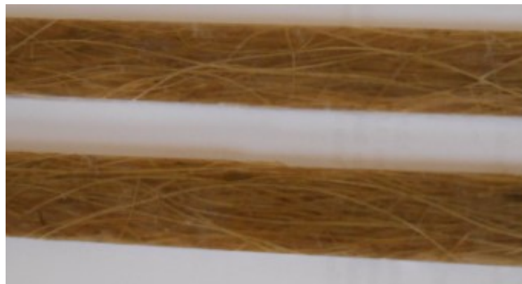
Figure 6.1. Modèle d'éprouvette à renfort de fibre long ( Cynara cardunculus L. )
