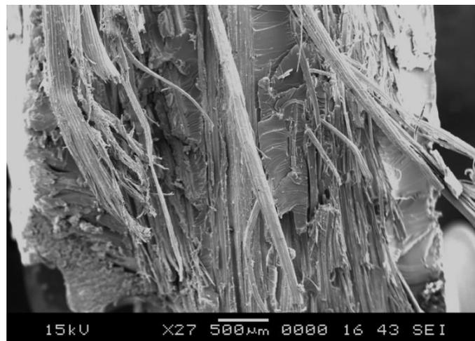
**Fig. IV.8** Image obtenue par MEB d'un bio-composite renforcé par des fibres de jute traitées par  $\text{NaHCO}_3$
