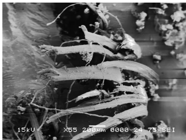
**Fig. IV.9** Image obtenue par MEB d'un bio-composite renforcé par des fibres de sisal traitées par  $\text{NaHCO}_3$
