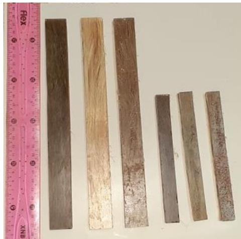
**Fig. II.11** Les éprouvettes de traction et flexion 3 points obtenus selon la norme ASTM D3039
