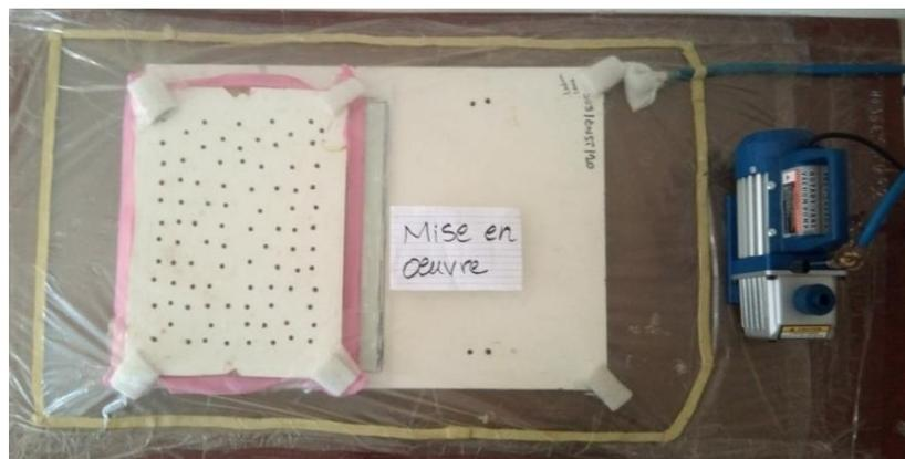
**Fig. II.8** Mise en œuvre des plaques en composites par le moulage sous vide
