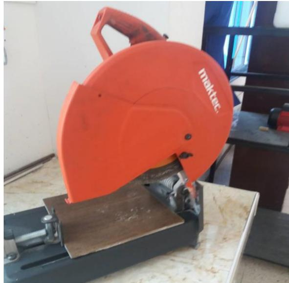
**Fig. II.10** Tronçonneuse à disque en diamant utilisée pour la découpe des plaques stratifiées
