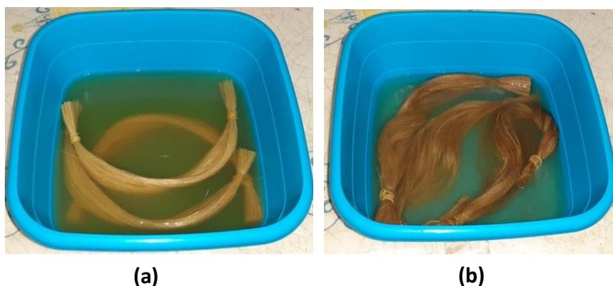
**Fig. II.4** Traitement chimique des fibres : **(a)** par NaOH et **(b)** par NaHCO<sub>3</sub>
