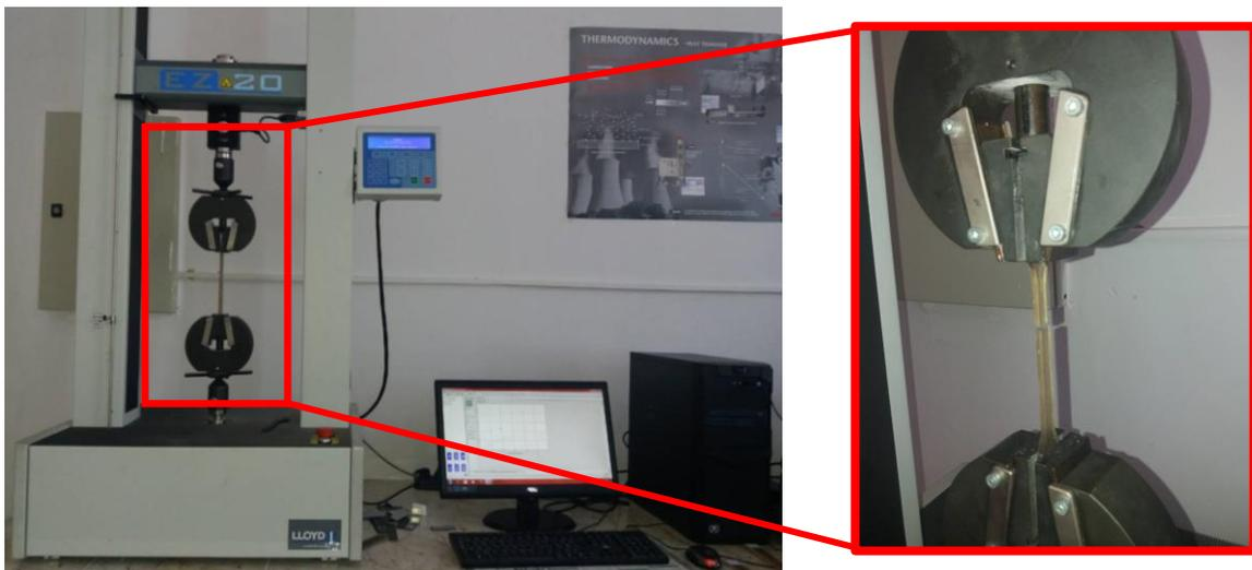
**Fig. II.27** Caractérisation des résines en traction jusqu'à la rupture
