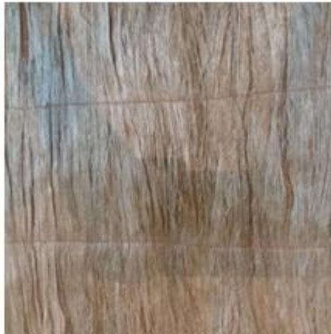
**Fig. II.7** Préparation des plis de fibre de lin couturés (300 × 300) mm
