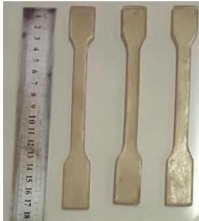
**Fig. II.26** Exemple des éprouvettes finies pour la traction
