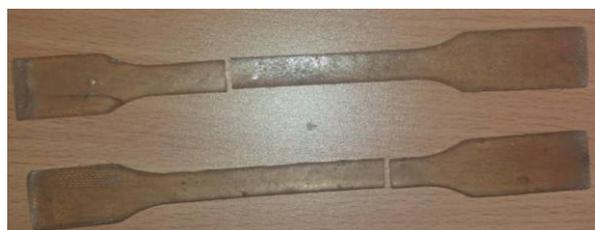
**Fig. II.28** Exemple d'une éprouvette en résines sollicitée en traction jusqu'à la rupture
