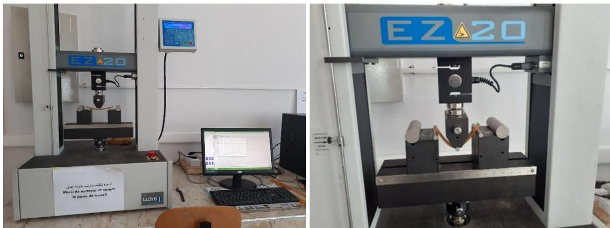
**Fig. II.30** Principe d'essai de flexion de résine
