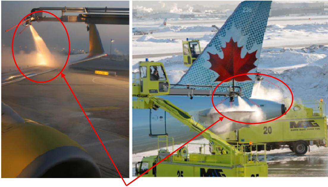
Dégivrage par un jet chaud impactant
