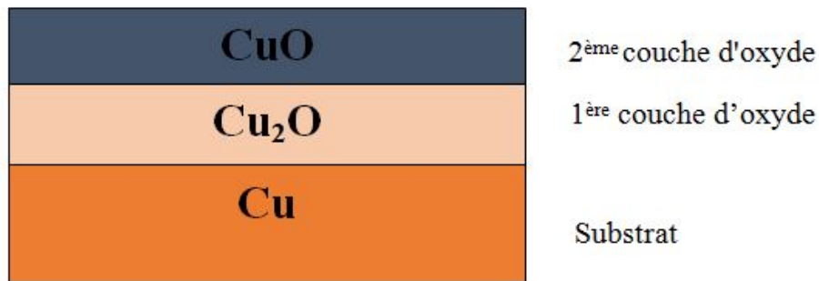
Fig. I. 19. Vue schématique de la superposition des couches d'oxyde sur le substrat.
