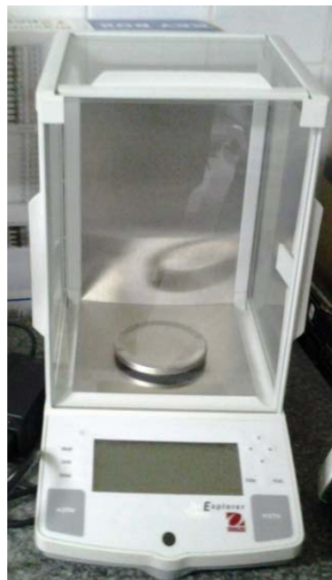
Fig. II. 11. Microbalance de précision 10^{-5} [g].
