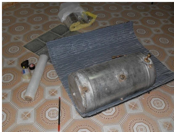
Figure II.24. Isolant thermique fixé à l'extérieur de la cuve.
