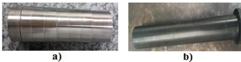
Figure III.2. Photos des éprouvettes : a) Essais de la rugosité, b) Essais d'usure et la température
