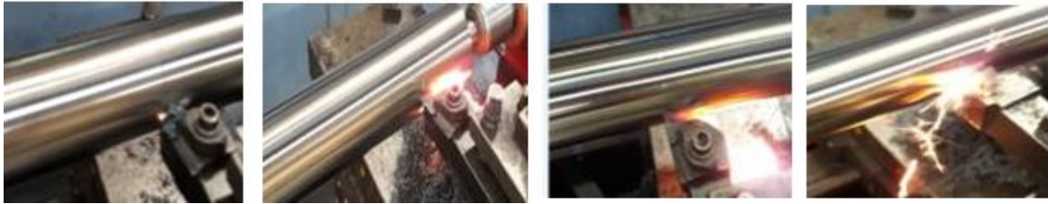
Figure V. 13. Evacuation de la chaleur par le copeau lors de l'usinage de l'acier 90 Mn Cr V8 par la céramique noire TC100, temps de coupe = 480s (8min); V_c = 180 m/min, a_p = 0,5 mm; f = 0,084 mm/tr; t^\circ copeau = 702 C°, t^\circ outil = 76 C°, t^\circ pièce = 48 C°
