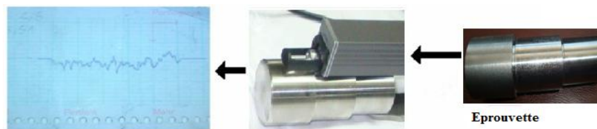
Figure III.8. Méthodologie de mesure de la rugosité
