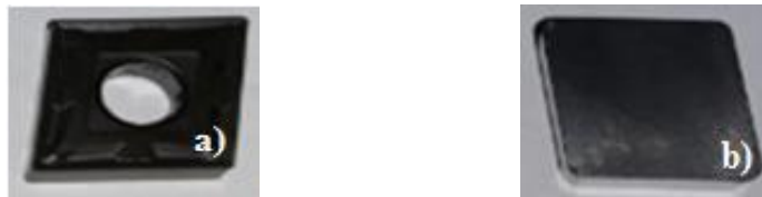
Figure III.5. Plaquette servant aux essais : a) Plaquette de carbure, b) Plaquette de la céramique noire
