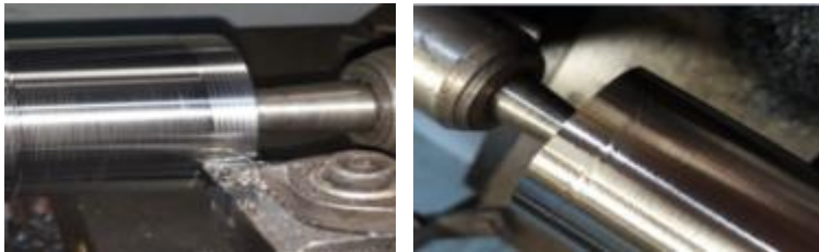
Figure V. 10. La trajectoire de l'outil en fonction de l'avance pour à a_p = 0.2 \text{ mm} et V_c = 200 \text{ m/min}
