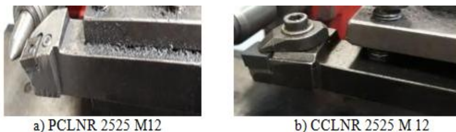
Figure III.6. Les porte-plaquette servant aux : a) Porte-plaquette de carbure, b) Porte-plaquette de la céramique noire
