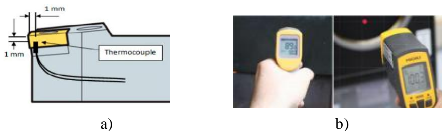
Figure I. 27. Mesure de la température : a) Par thermocouple, b) Par le pyromètre infrarouge [39]
