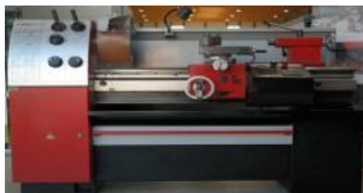
Figure III.1. Tour parallèle conventionnel
