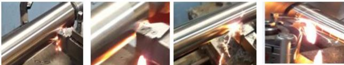
Figure V. 12. Evacuation de la chaleur par le copeau lors de l'usinage de l'acier 90 Mn Cr V8 par le carbure T9325, temps de coupe = 480s (8min); V_c = 180 m/min, a_p = 0,5 mm; f = 0,084 mm/tr; t^\circ copeau = 840C^\circ , t^\circ outil = 85C^\circ , t^\circ pièce = 60C^\circ
