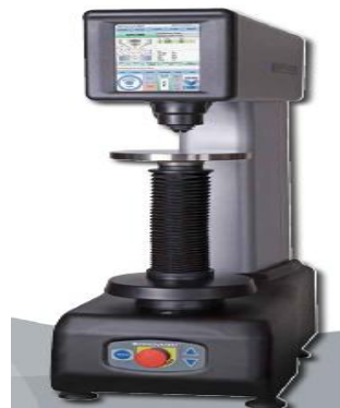
Figure III.4. Machine d'essais de dureté brinell « INNOVATEST », série VERZUS 710
