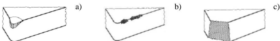
Figure II.6. Autres forme d'usure : a) Par déformation plastique, b) Par écaillage et fissuration d'arête c) Par rupture brutale du bec d'outil [38]
