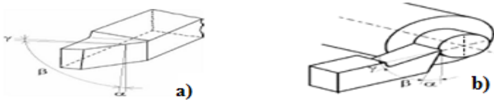
Figure I. 12. Angles du taillant : a) outil en main, b) outil en travail [22]
