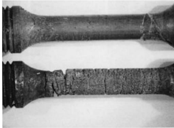
Figure I.3: Eprouvettes ayant séjourné dans un bain d'acide, l'échantillon supérieur était exempt d'effort, l'échantillon inférieur a été soumis à une charge constante [4].
