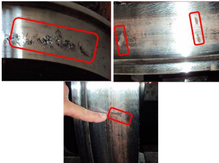
Figure II.12 : Photo des roues endommagées de l'autorail prises à l'AMF
