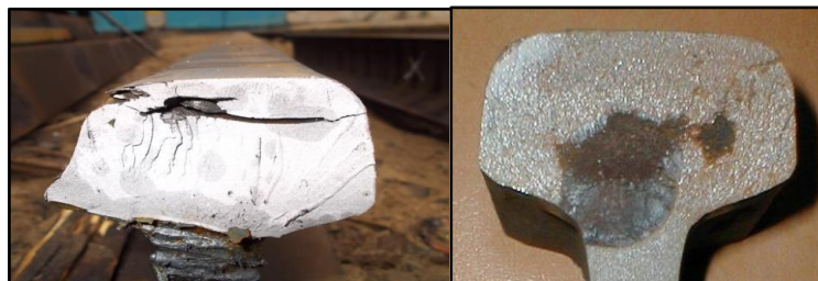
Figure I.17: Défauts de rail: a) Fentes transversales dans la tête de rail; b) Fissures transversales dans la tête du rail [22].
