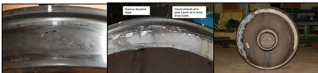
Figure I.2: Écaillage sur la table de roulement d'une roue correspondante dans le méplat non critique
