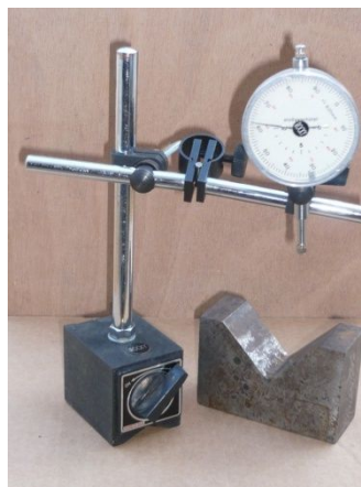
Figure III.6: Comparateur de la mesure de la profondeur du cratère.
