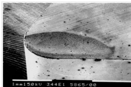
Figure I.16: Cratère formé par usure par diffusion sur une plaquette carbure après 20 S d'usinage d'un acier AISI 1020 avec une vitesse de coupe de 300 m/min [Geko, 2002].
