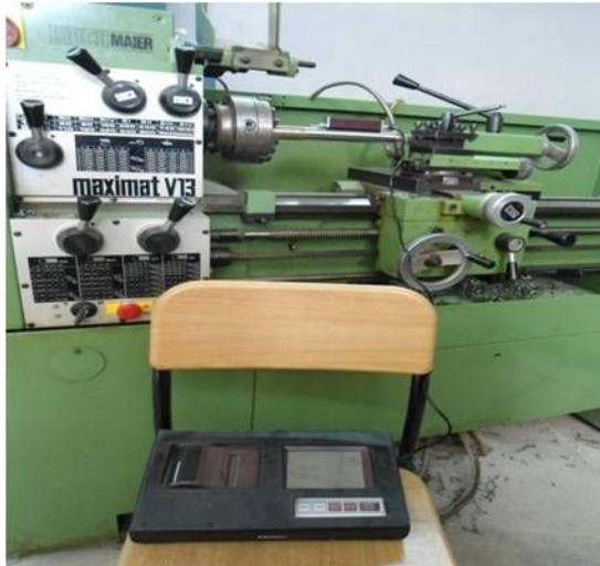
Figure III.8: Mesure des différents critères de rugosité sans démontage de la pièce.
