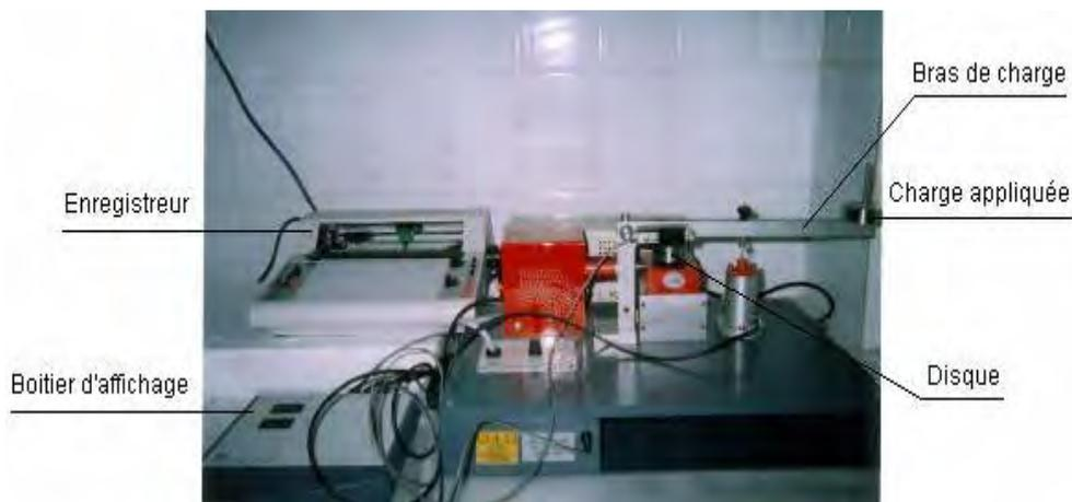
Figure V.6 : Tribomètre pion-disque.
