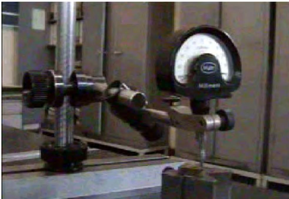
*Figure 2.2 : Dispositif de mesure de l'usure en cratère*
