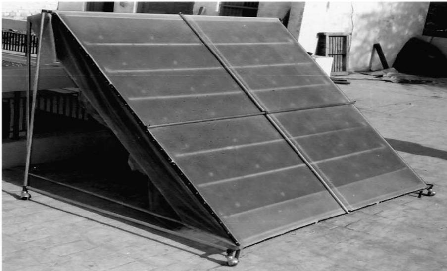
**Figure I.12: Schéma d'un séchoir solaire direct à convection naturelle**
