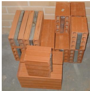
Figure II.20. Intégration des matériaux à changement de phase dans la brique [195].
