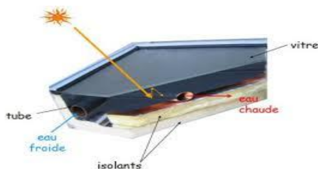
Figure I.5. Principaux composants d'un collecteur solaire plan à eau [7]
