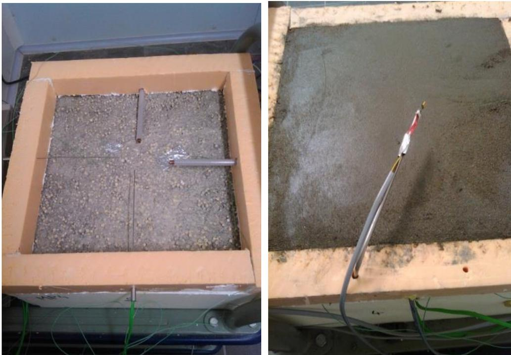
Figure III.12. Photos de l'échantillon avant et après coulage du mortier de ciment
