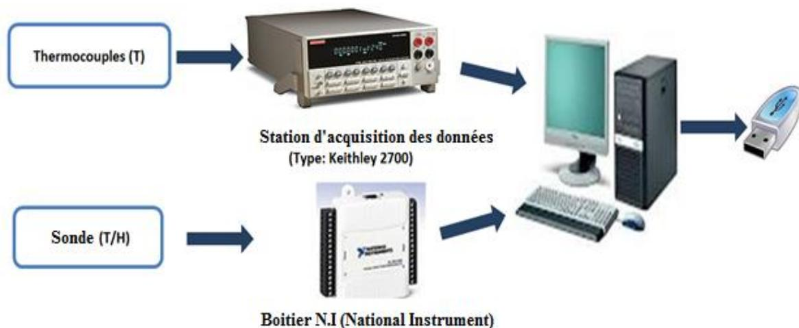
Figure III.37. Chaîne d'acquisition
