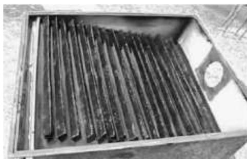
**Figure.11.1.** Distillateur avec la feuille en aluminium pliée, perforée flottant sur la surface de l'eau
