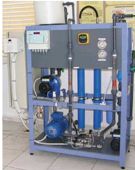
Figure IV.7 : Unité d'osmose inverse autonome
