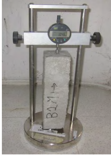
Figure 3.19. Essai de retrait
