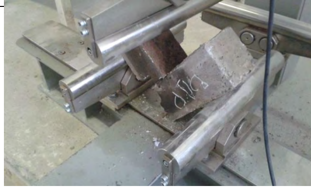
Figure 3.15. Essai de traction par flexion (b)
