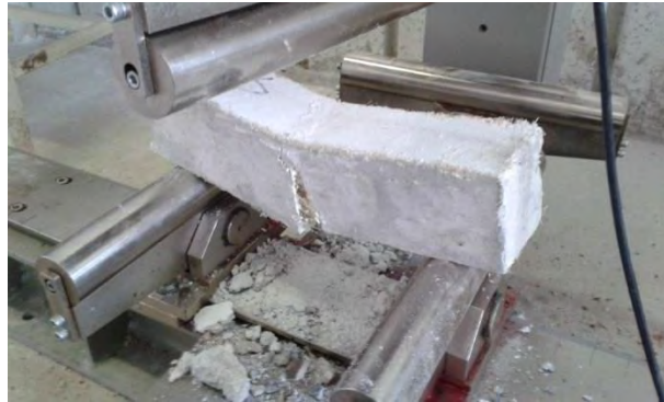
Figure 4.6. Essai de traction par flexion sur un béton de fibres de chanvre
