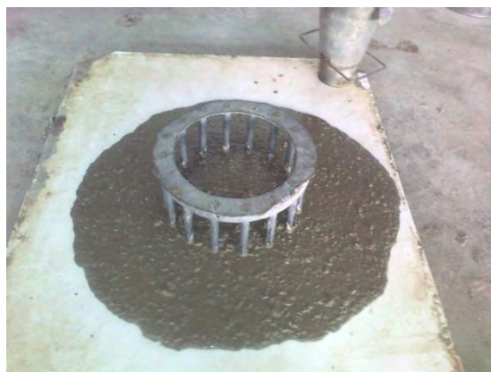
Figure 3.8. Essai des anneaux Japonais
