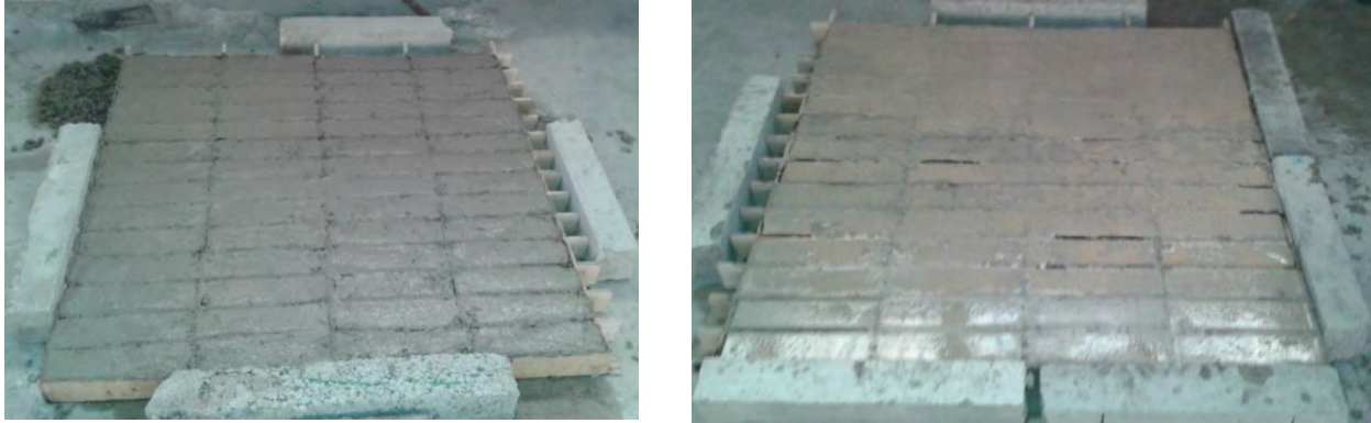
Figure 3.12. Moules utilisés pour bétons ordinaires (A) et bétons autoplaçants (B)
