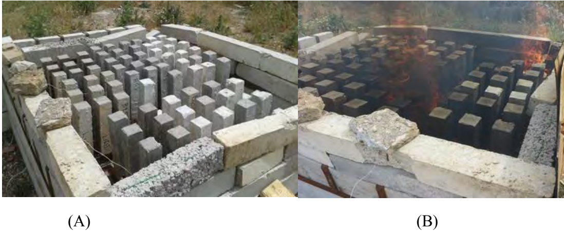
Figure 3.14. Disposition des éprouvettes dans le foyer de feu (A) et essai au feu (B)
