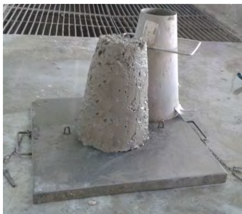
Figure 3.6. Essais d'affaissement au cône d'Abrams
