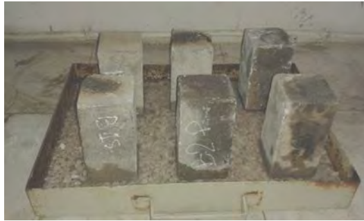
Figure 3.18. Essai d'absorption capillaire
