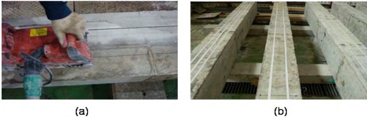
Figure III-2 : Préparation des spécimens : (a) découpage des engravures, (b) : lamelles PRFC après insertion.
