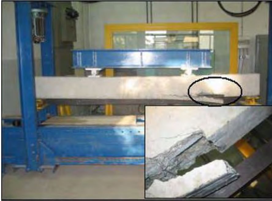
Figure III-21 : Mode de ruine de la poutre S-C (FPT) (210)
