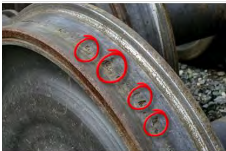
Fig. I.12. Les défauts de la roue
