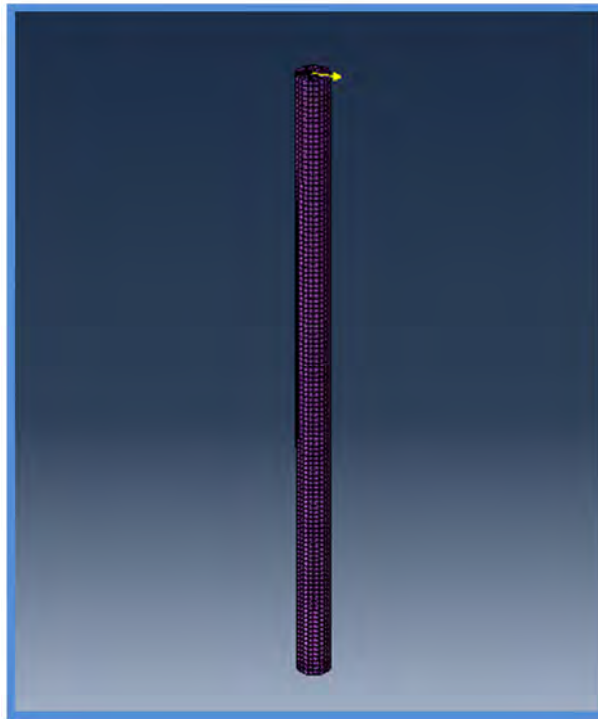
Figure V.9. Pieu isolé sous chargement latéral cyclique (ABAQUS 6.10).
