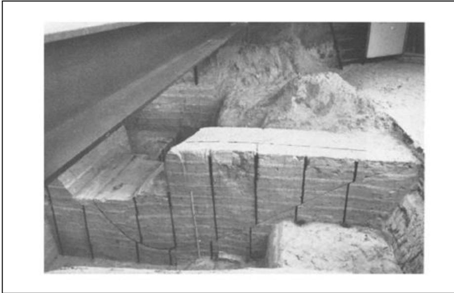
Figure (VI. 3) Mécanisme de défaillance dans la tentative de soulèvement à grande échelle
