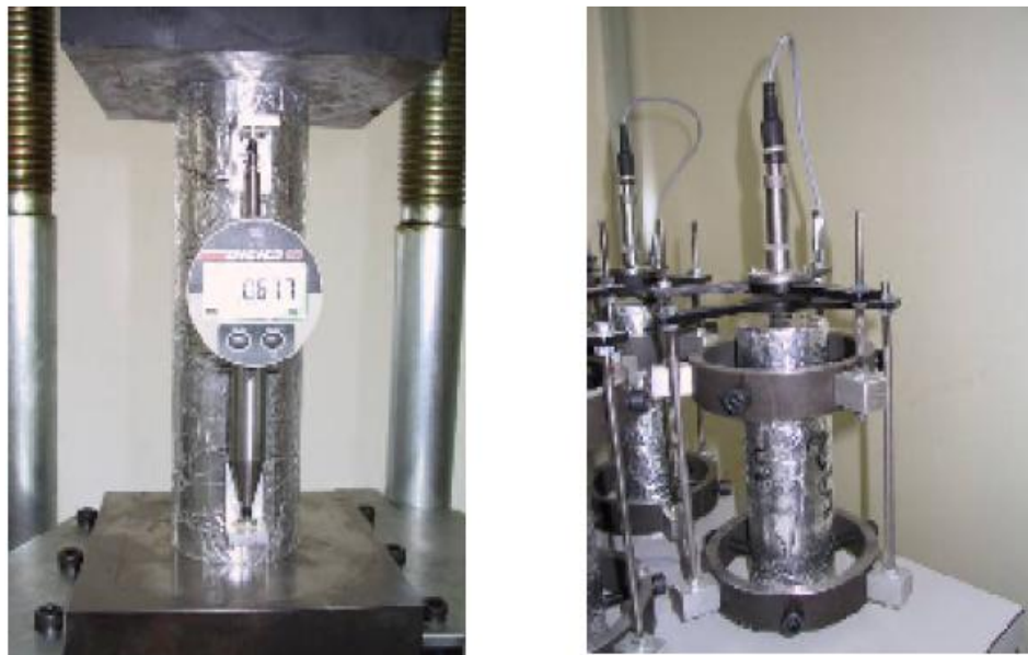
Figure I-3-21: Dispositif de mesure de fluage en compression [ A. Kamen, 2007 ]
