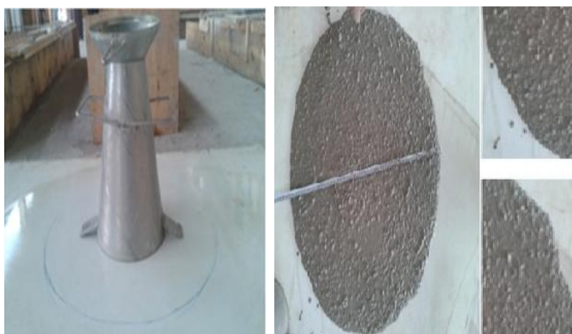
Figure II-2-2: Etalement satisfait d'un béton autoplaçant (BAP homogène).
