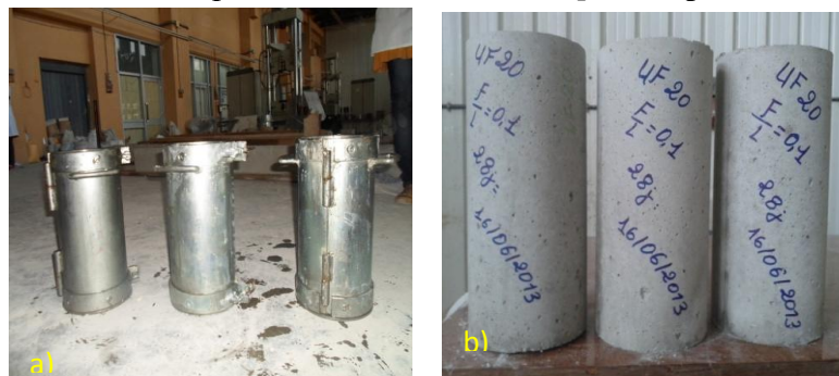
Figure II-1-13 : a)Moules cylindriques (16x32) cm 2 pour moulage des éprouvettes de béton, b) Eprouvettes cylindriques (16x32) cm 2 destinées à l'essai de compression.
