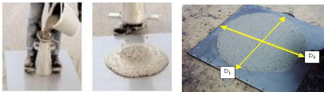
Figure I-1-11: Principe de la mesure de l'étalement.
