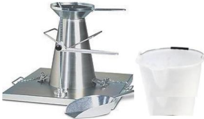
Figure B-1 : Matériels nécessaires pour l'essai d'étalement.
