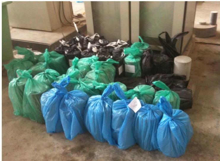
Figure II-1-17: Conservation des éprouvettes destinées à l'écrasement (compression et traction par flexion).
