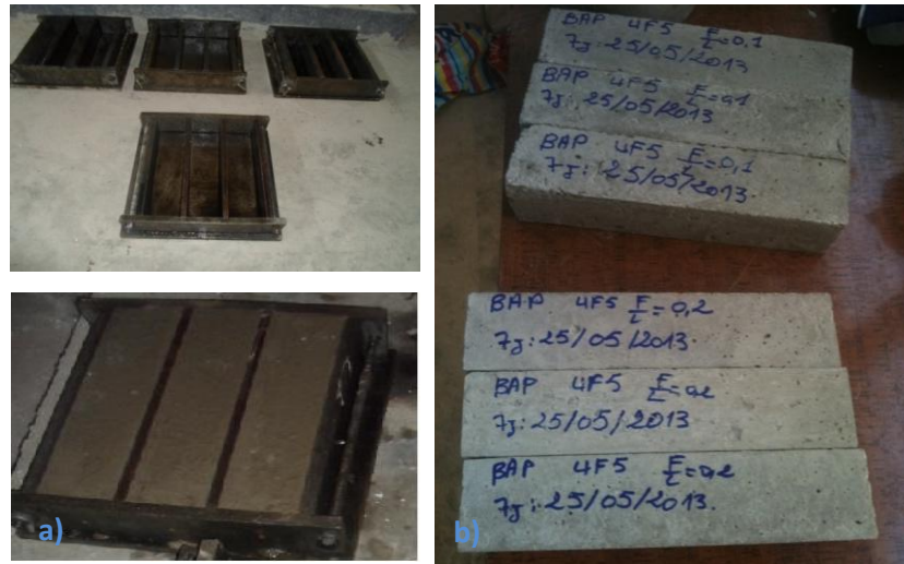
Figure II-1-14 : a) Moules prismatiques (7x7x28) cm 3 pour moulage des éprouvettes de béton, b) Eprouvettes prismatiques (7x7x28) cm 3 destinées à l'essai de traction par flexion.
