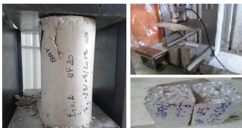
Figure II-1-21 : Ecrasement des éprouvettes : Cylindre (Compression), Prisme (Traction par flexion).
