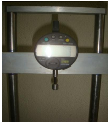
Figure II-1-22 : Comparateur avec une exactitude \geq 0,005 \text{ mm}
