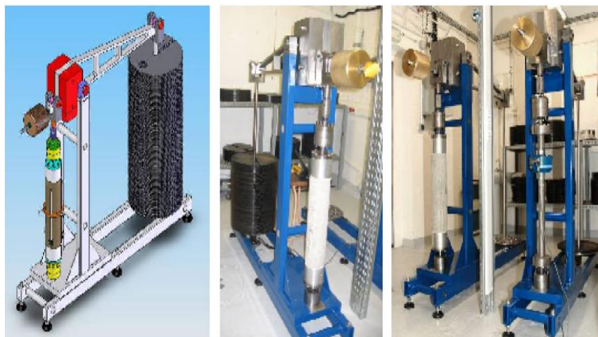
Figure I-3-20 : Vue d'ensemble du bâti de fluage en traction. [N. Reviron, 2009]
