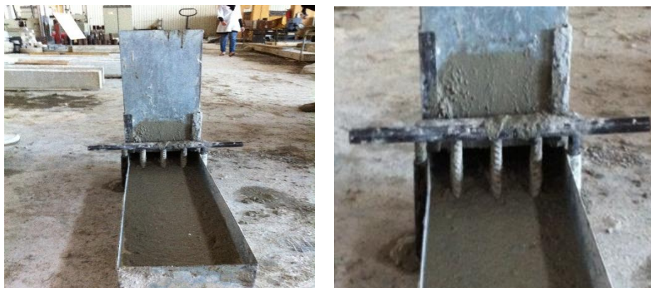
Figure II-2-3: Passage du BAP à travers les armatures sans blocage.
