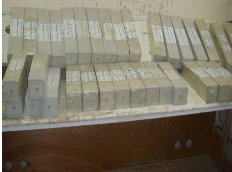
Figure II-1-25: éprouvettes prismatiques munies de plots.
