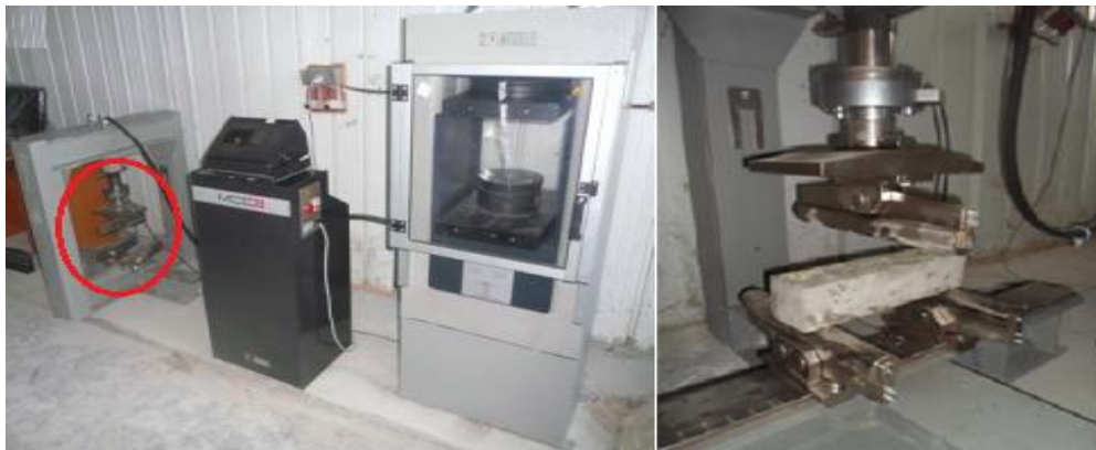
Figure C-6: Machine et dispositif de l'essai de traction par flexion.
