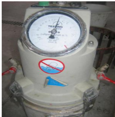
Figure I-1-16: Mesure de l'air occlus à l'aide d'un aéromètre.
