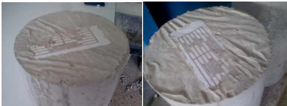
Figure 36. Mauvais surfaçage des éprouvettes
