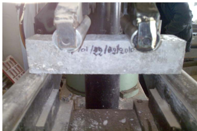
Figure 20. Essai de traction par flexion
