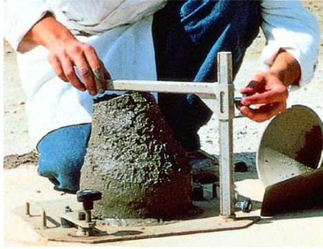
Figure 3 : Mesure de l'affaissement. [11]
