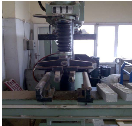
Figure 21. Machine d'essai de traction par flexion
