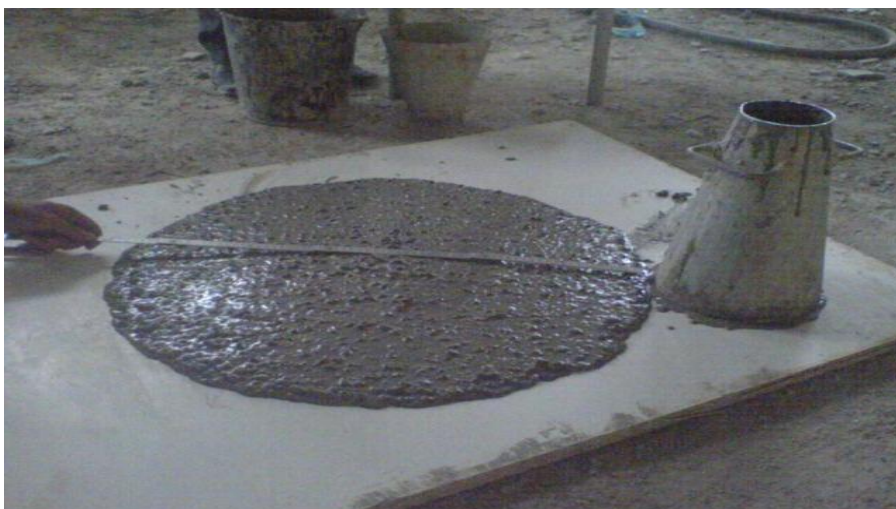
Figure 3.1 : résultat d'essai d'étalement
