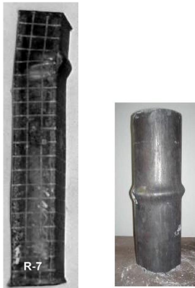
Figure 1.10 : Voilement local des sections mixtes [6,7].
