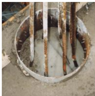
(b) Profil creux rempli de béton
