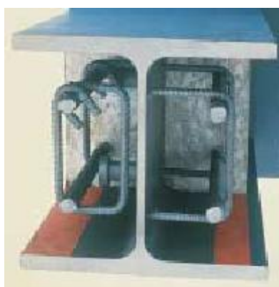
(a) Profilé partiellement enrobé
