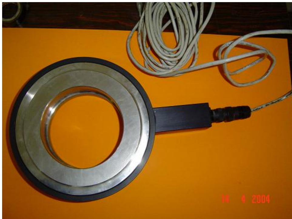
Photo 5-4 Le capteur de force utilisé dans l'essai
