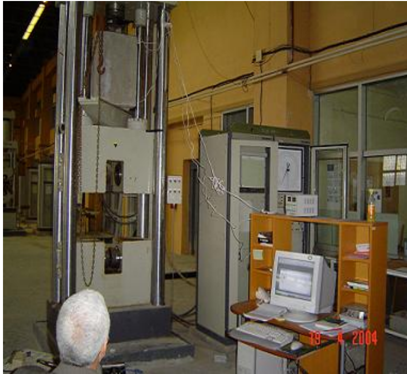
Photo5-11 la machine d'essai et dispositif des mesures
