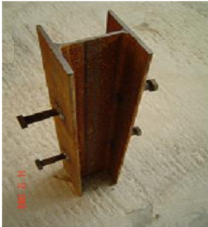
photo 5-1 profilé avec connecteurs en goujon
