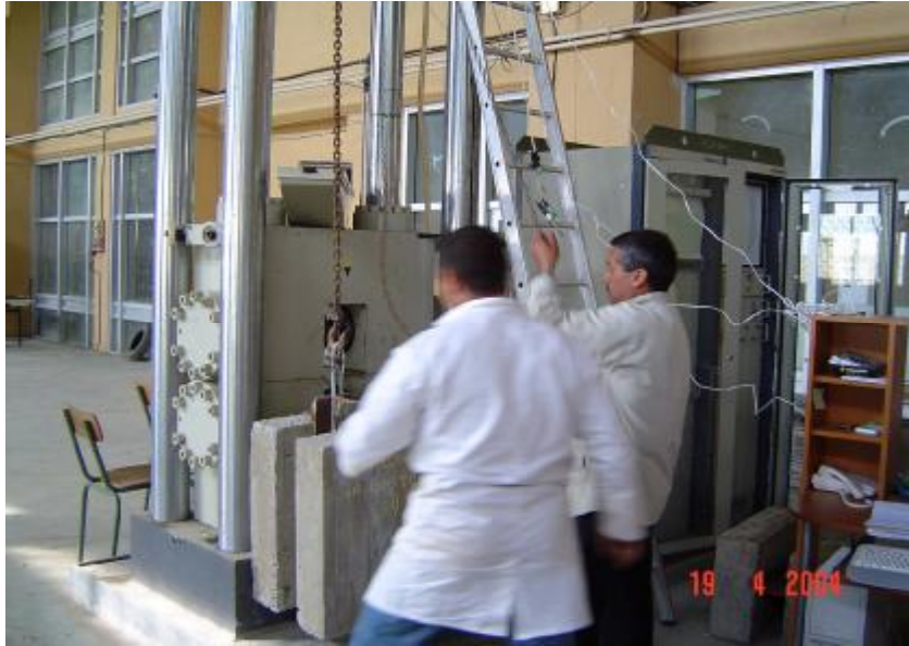
Photo 5-14 le montage des spécimens
