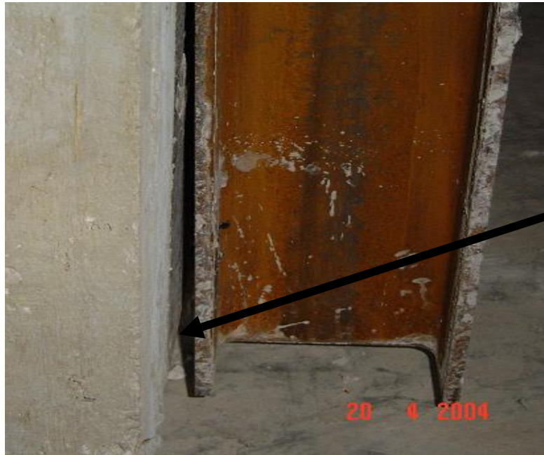
Photo 5-18 :décollement observé après essai push-out du CG 1
