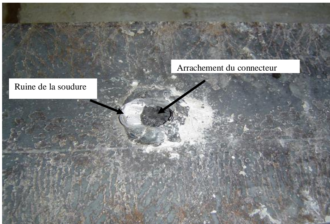
Photo 5-19 :1 er mode de ruine « rupture du cordon la soudure » essai push-out du CG 1
