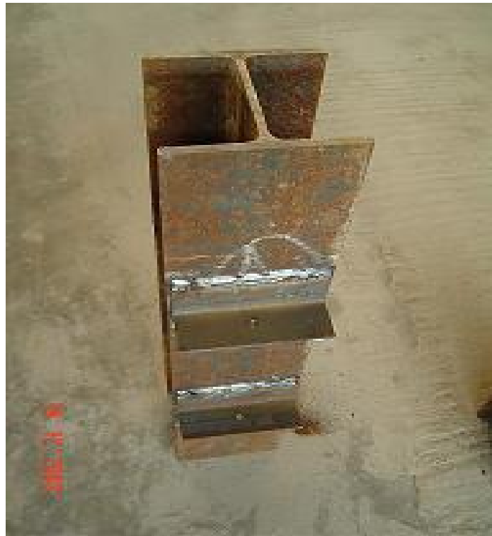
Photo 5-2 profilé avec connecteurs en cornière
