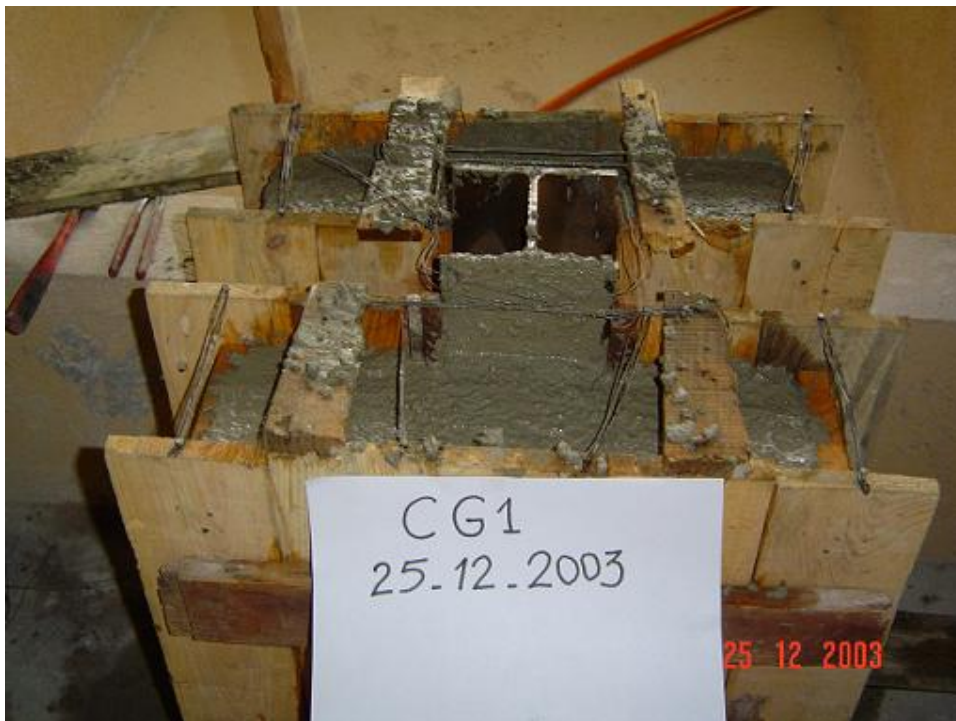
photo 5-9 coffrage et coulage du béton pour le spécimen CG1
