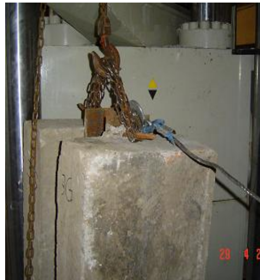
Photos 5-12et 5-13 utilisation d'un palan pour le soulèvement et le montage des spécimens
