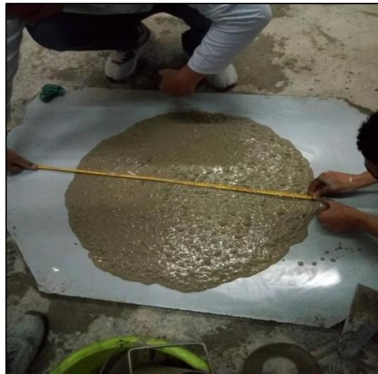
Photo 5.3 : Essai au cône d'Abrams.
