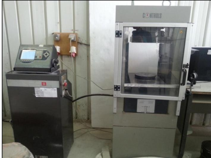
**Photo 5. 4 :** Presse d'essai (CONTROLS).
