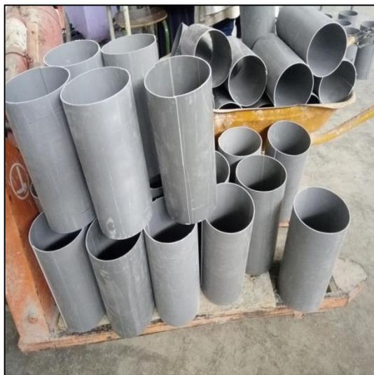
**Photo 5. 6 : Tubes en PVC pour coffrage et/ou confinement.**
