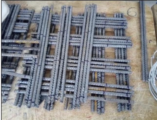
Photo 5. 1 : Barres longitudinales  $\text{Ø}8\text{mm}$ .
