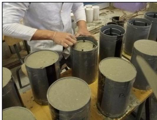
Photo 5.7 : Confection des spécimens : ferrailage, coffrage et coulage des spécimens
