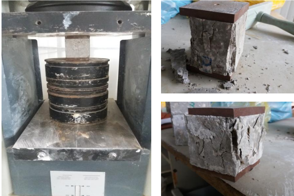
Figure 2.19 Essai de la résistance à la compression simple
