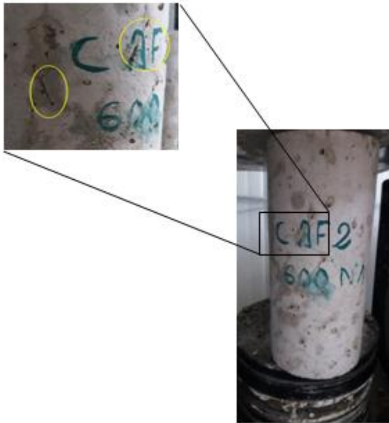
Figure 4.13. Fusion et la combustion de la fibre d'alfa à 600°C
