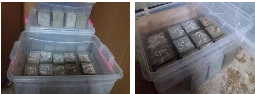
Figure 2.17. Protocole de l'immersion complète des éprouvettes dans la solution saline à 5 % en masse de \text{Na}_2\text{SO}_4 .
