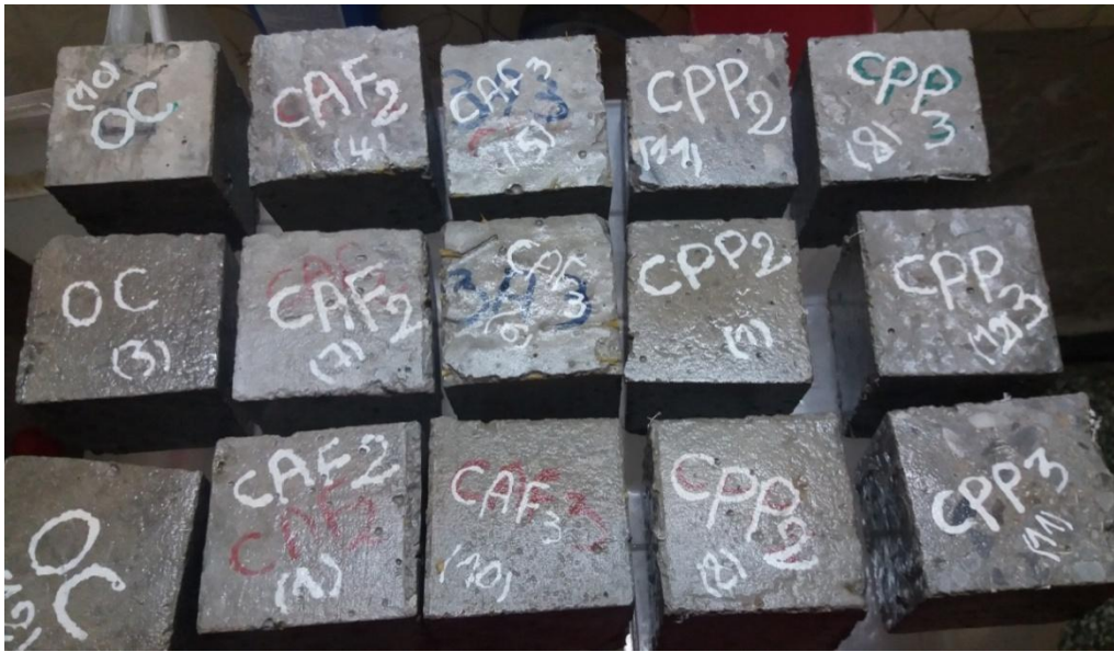
Figure 4.19 Photo des échantillons après une année d'immersion complète
