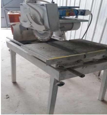
Figure 2.11 L'appareil de scie pour découper les éprouvettes de béton.
