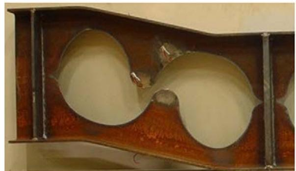
Photo 1-4 : *Rupture de la soudure [53].*
