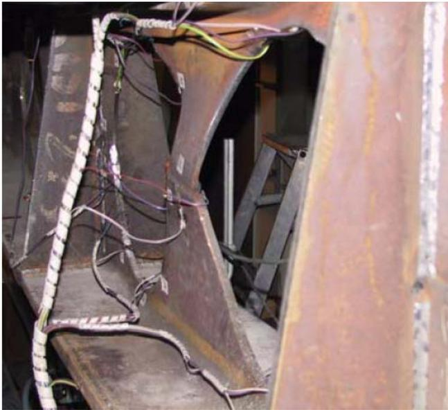
Photo 1-2 : *Flambement des montants par compression [17]*
